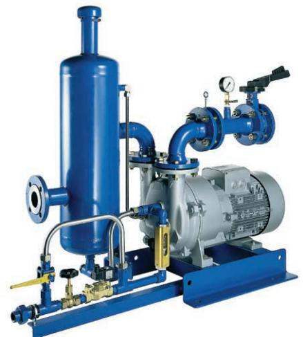
■ **erweitert um Ausbau-Option I03:** Magnetventil, Bypass mit Absperrkugelhahn und Durchflussmesser mit Alarmschalter bei zu niedrigem Zufluss in der Betriebswasserzuführung
